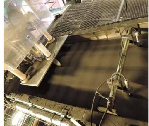
Die tripolare Mess-Elektrode TFS141 misst den Feuchtegehalt des Kreislaufsands auf dem Fließband.
