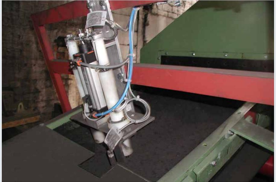
**Aufgabe:** Der Wasseranteil im Rücklaufsand ist der Teil im gesamten Sandhaushalt, der den meisten Schwankungen unterliegt und hohen Einfluss auf die Formsandqualität hat. Voraussetzung für eine automatische Wasserdosierung, die einen gleichmäßigen Feuchtegehalt hinter dem Kühler und hinter dem Mischer erreichen soll, ist eine Feuchtemessung, die **in allen Feuchtestufen und in allen Temperaturbereichen korrekt misst.**
